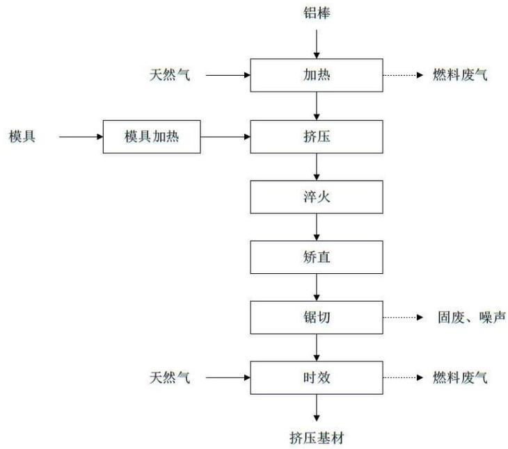
图2 挤压、时效车间生产工艺流程
