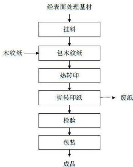
图 6 木纹隔热车间生产工艺流程
