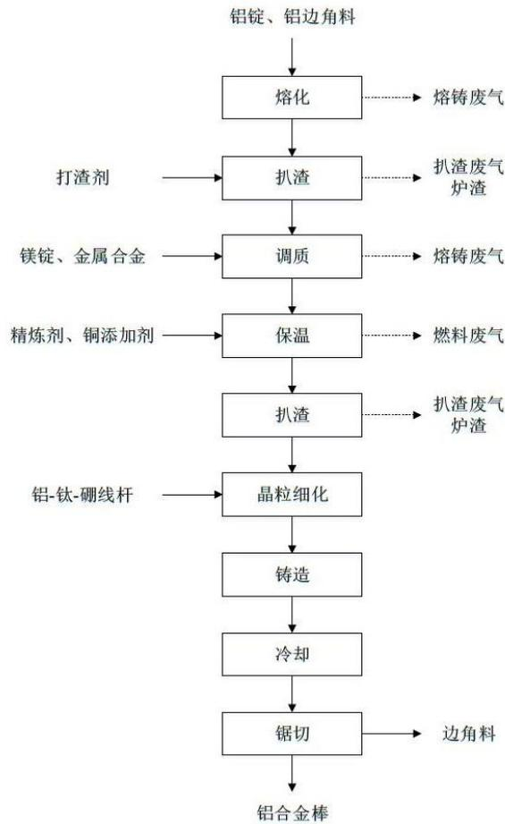
图 1 熔铸车间生产工艺流程图
