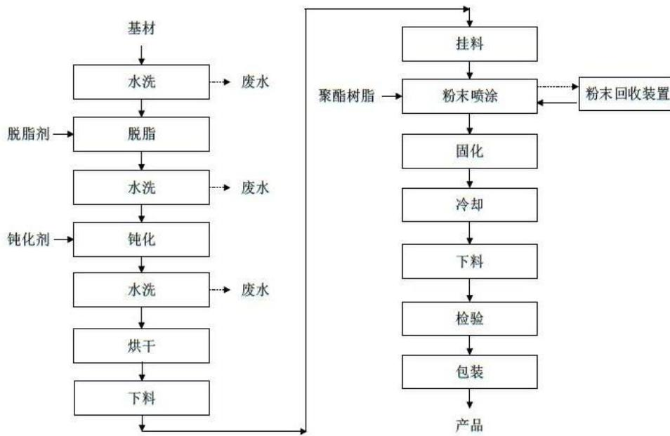
图 1.4.5 喷粉生产线生产工艺及产污环节图
