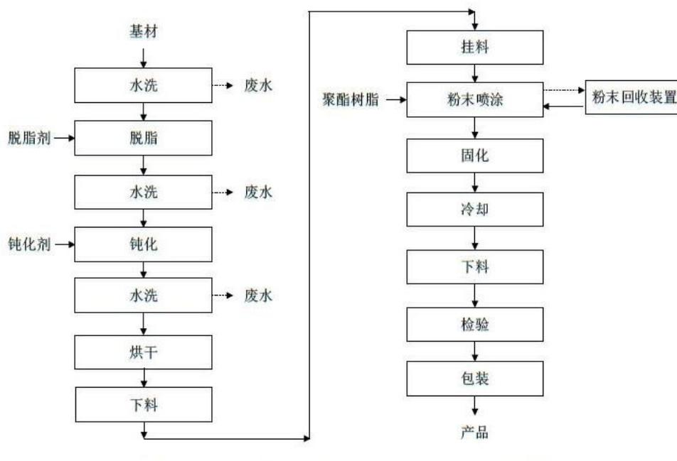
图 5 喷粉生产线生产工艺流程
