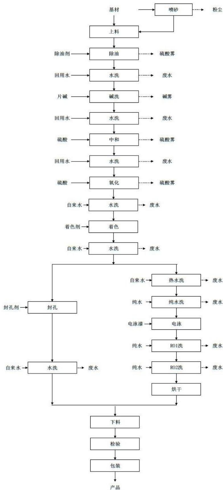
图 3 氧化生产线生产工艺流程
