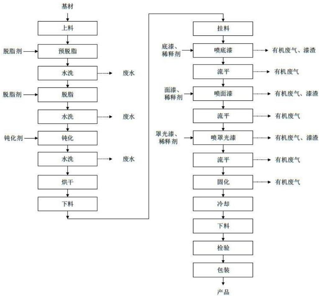
图 4 喷漆生产线生产工艺流程
