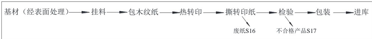
木纹型材生产线工艺流程示意图
