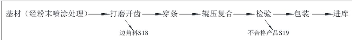
隔热型材生产线工艺流程示意图
