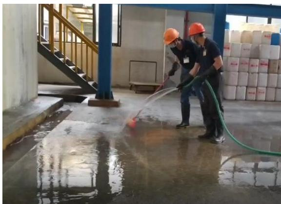
洗消废水扫入污水沟，排入污水站
