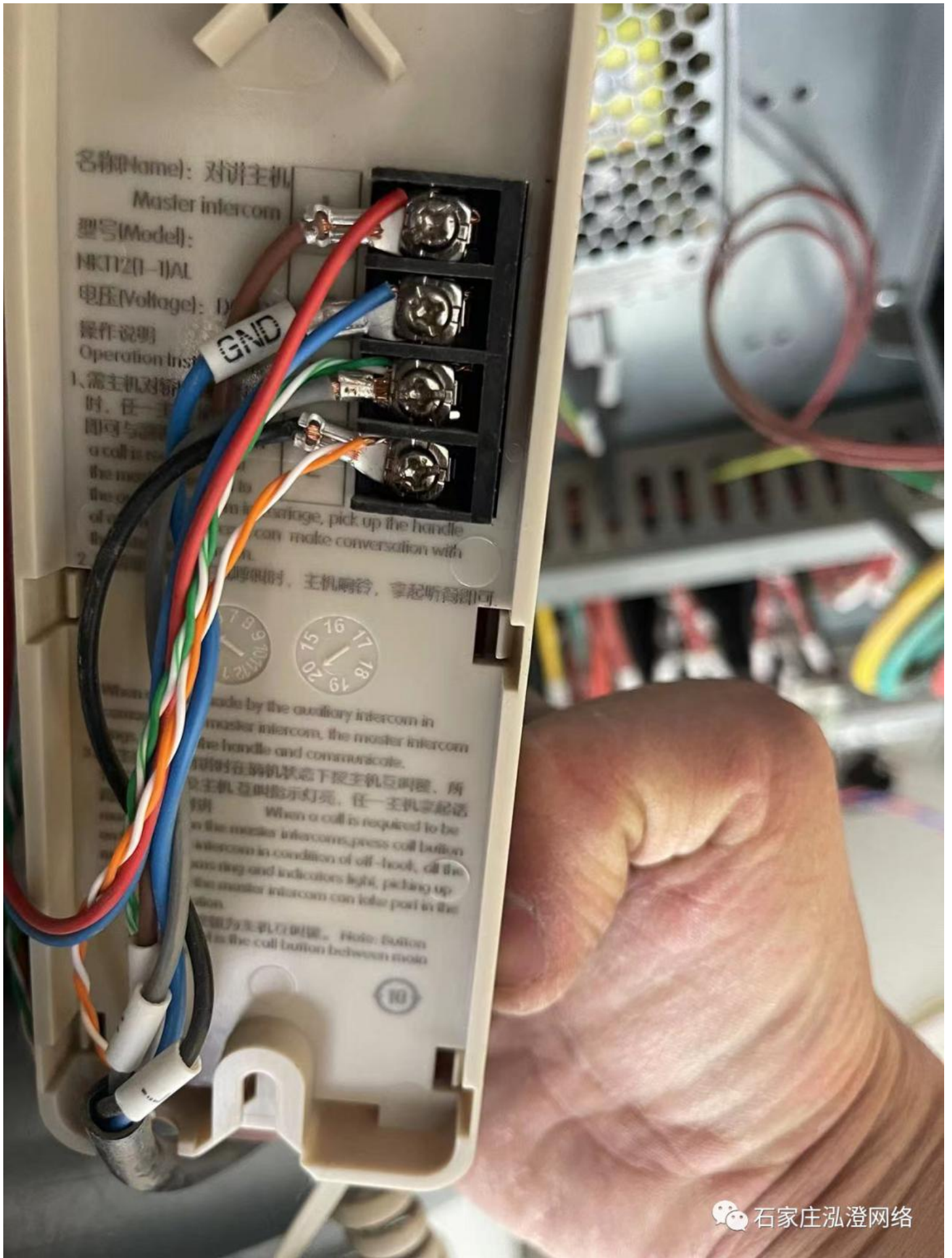
此型号话机为四线制，分别为 12V,GND，R,L,此话机可用兼容四线制分机。
