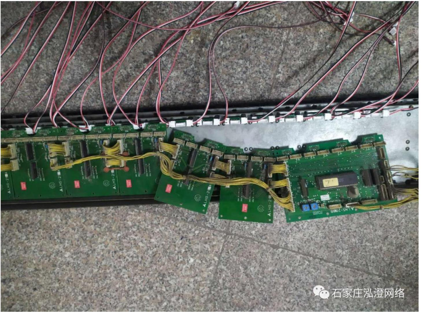
把转接头分出来的控制线连接到主板对应楼层接口即可。
