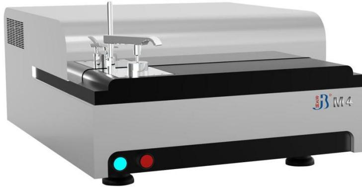
M 系列全谱直读光谱仪采用国际标准的设计和制造工艺技术，全数字化及互联网技术结合，运用高分辨率 CMOS 检测器，精密设计的氩气吹扫系统，使仪器具有极高的性能、极低的成本、以及极具竞争力的价格。
