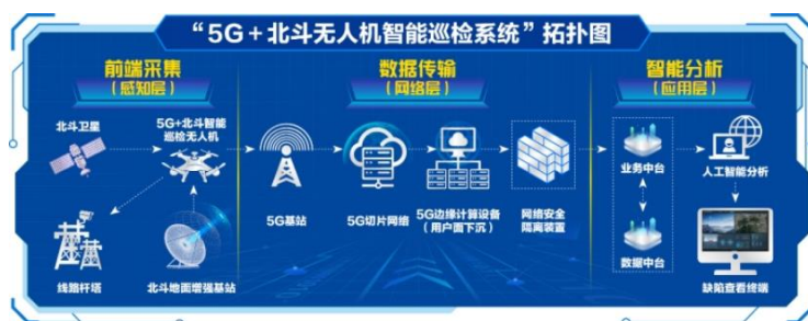
图 3-45 基于 5G+北斗的无人机智能巡检系统
