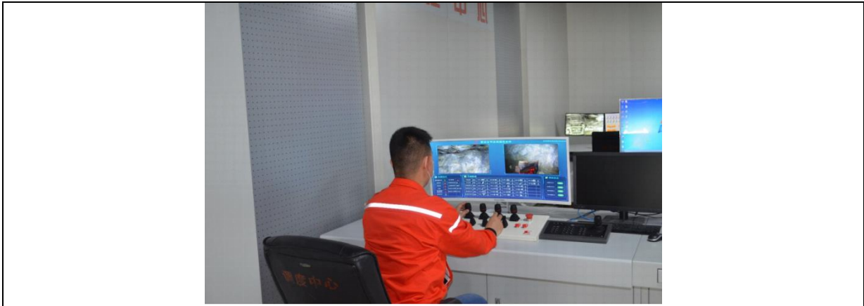
图 3-40 5G 无人化掘进操控台
