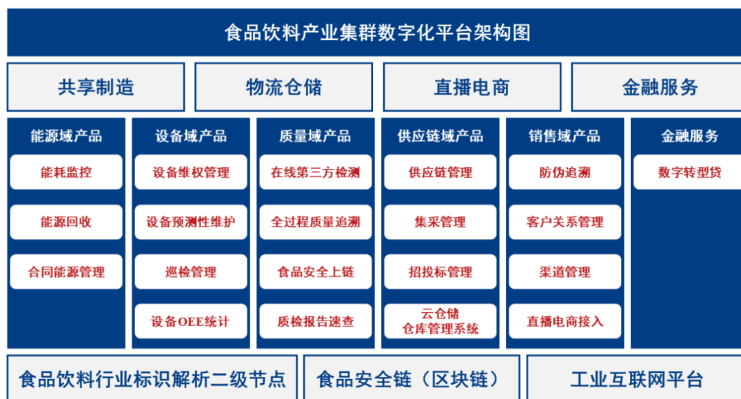
图 3-11 食品饮料产业集群数字化平台架构图
