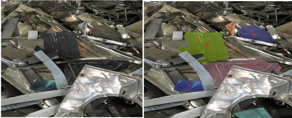
图 4-6 基于机器视觉的方式对废钢进行自动识别和智能定级
