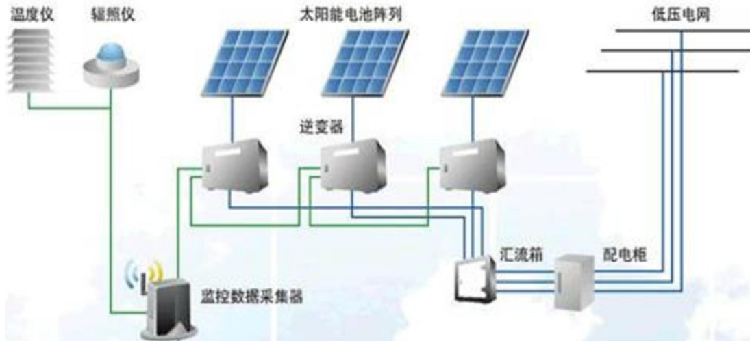
图 4.3-3 光伏发电技术原理
