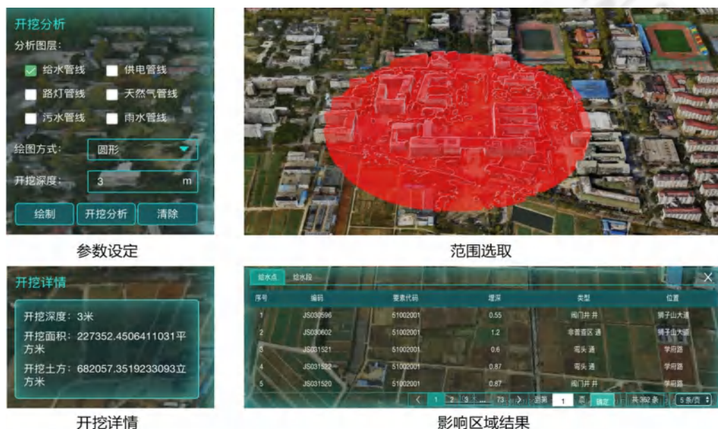
图 124 管线开挖模拟分析
