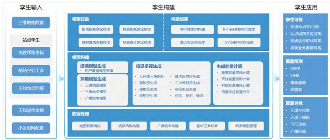
图 69 数字孪生平台架构
