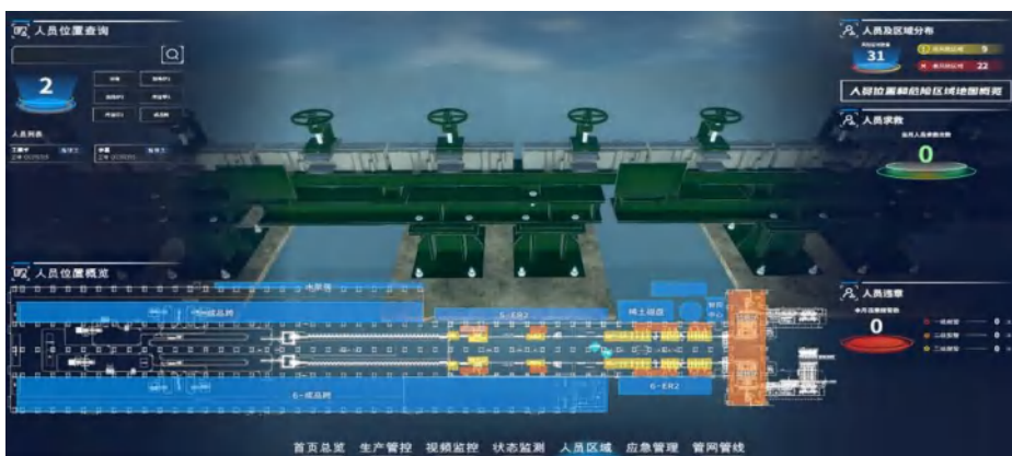
图 254 基于 UWB 安全定位技术的三维可视化人员管理系统
