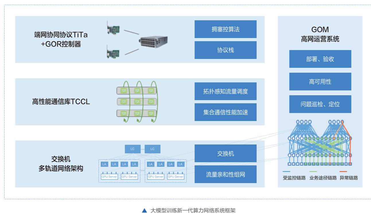
大模型训练新一代算力网络系统在大规模组网上，采用无阻塞胖树（Fat-Tree）拓扑，分为Block-Pod-Cluster三级。
