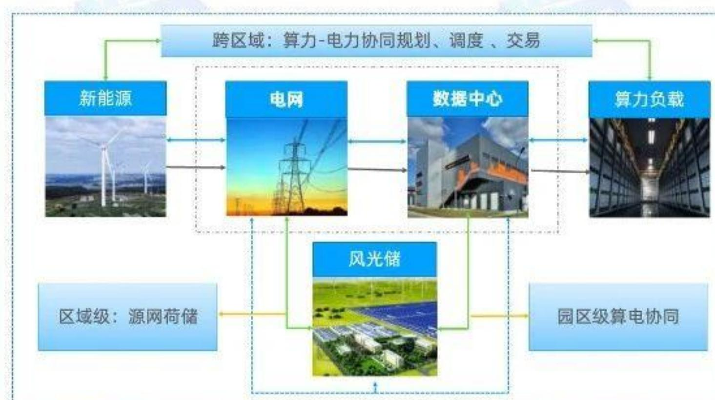
图 2 算电协同总体架构图
