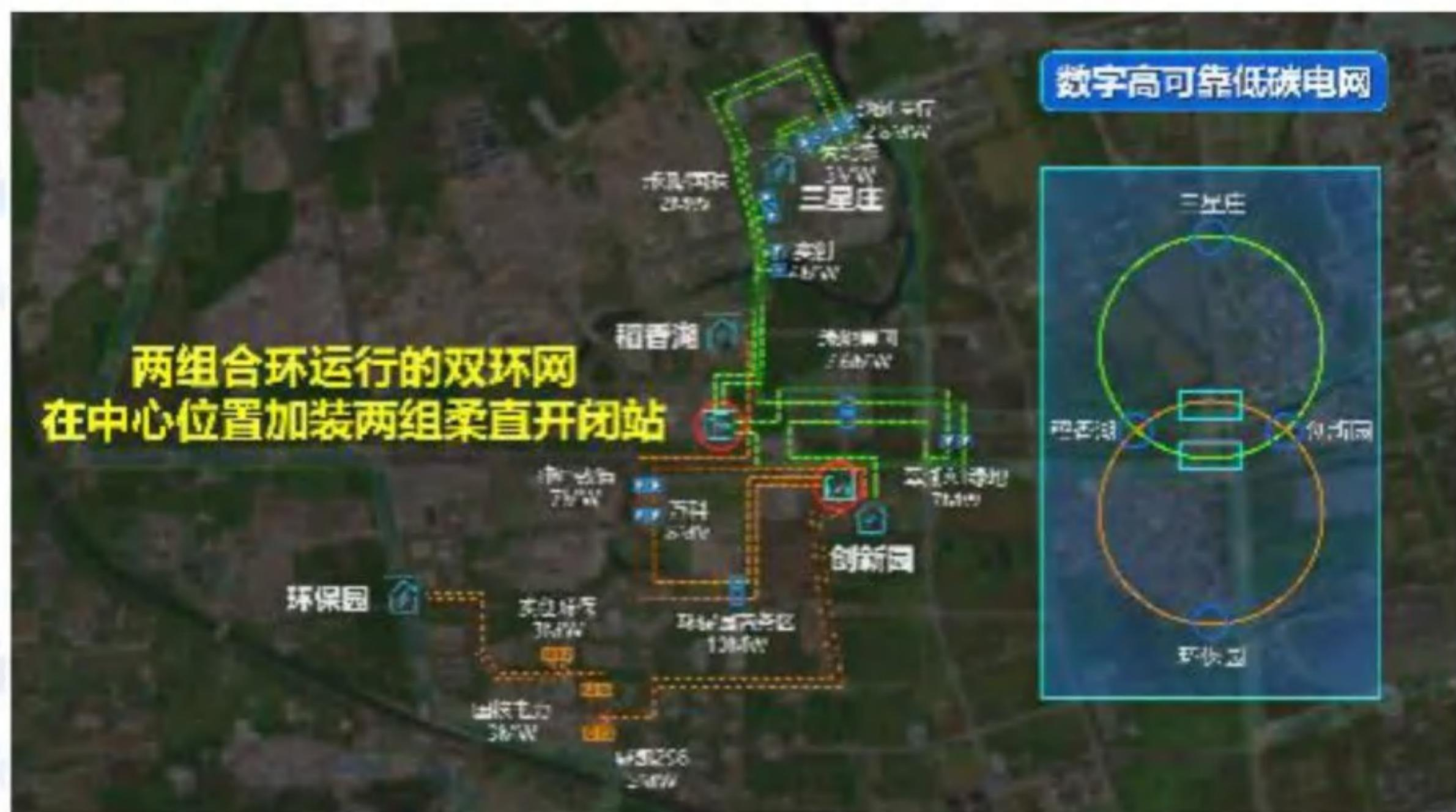
图2 柔性直流开闭站与数字高可靠低碳电网示意图
