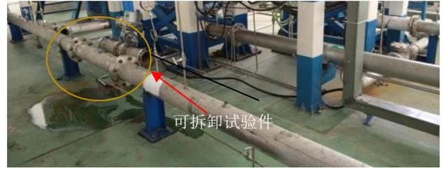
图1 试验管道图
