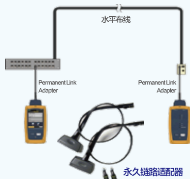
(一) Permanent Link 永久链路测试模型
