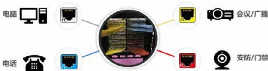
综合布线涉及的应用子系统越来越多，已经远远超出了只有电话和电脑的范畴，所以用不同的颜色来定义不同的应用子系统，通过颜色来进行管理和区分是大势所趋。比如用蓝色代表语音电话系统；用白色（灰色）代表电脑网络系统（如有内外网之分的，还可以用绿色或者其他颜色表示）；用红色代表门禁/安防系统；用黄色代表会议/广播系统等等.....目前在国际标准中还没有统一的颜色规定，用户可以根据自身的项目情况来自定义自己喜欢的颜色。通过颜色来区分和管理不同的子系统，极大的方便了系统维护人员，可以快速定位不同的应用，是整个综合布线系统安全、稳定运行的有力保障。
