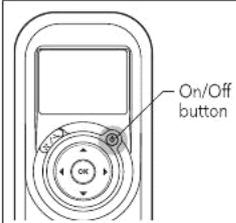
1. 按 On/Off 开关按钮一次。遥控器在手动直接控制模式。
