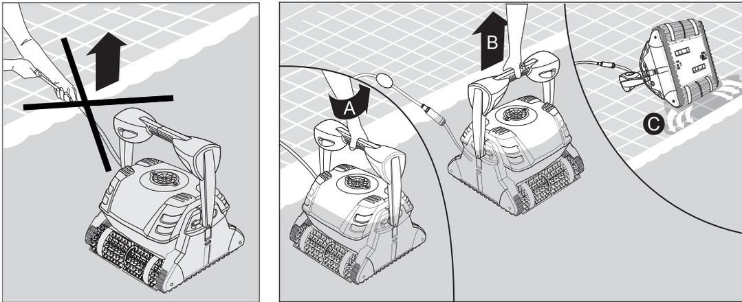
使用浮动电缆，把吸污机带到泳池边缘。
