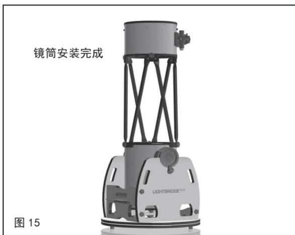
4、主镜笼和副镜笼安装到位后，拧紧6颗固定螺丝（6和8）。
