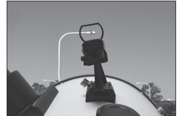
1、顺时针旋转红点寻星镜电源开关，直到你听到咔嚓一声，打开红点寻星镜。继续转动红点寻星镜电源开关，亮度达到最大。调节到合适的亮度。
