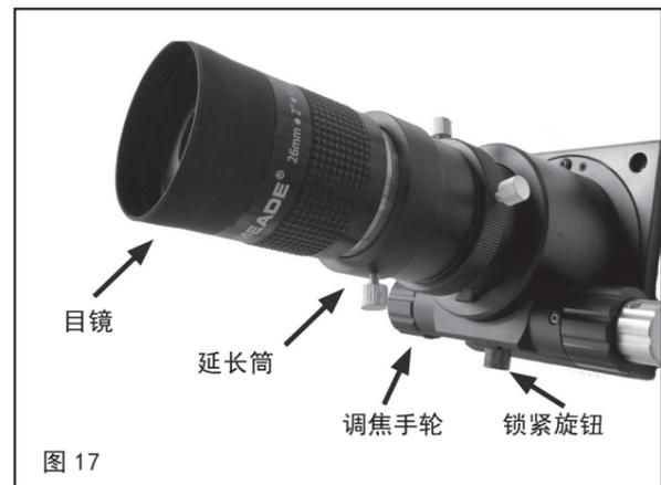
调焦座有一个锁紧旋钮（25）。这个旋钮完全拧入可以固定调焦筒，在不同深度可以调节阻尼。如果你使用了比较重的目镜或配件，可能需要把旋钮拧入一些，这样可以保证调焦筒不打滑。
