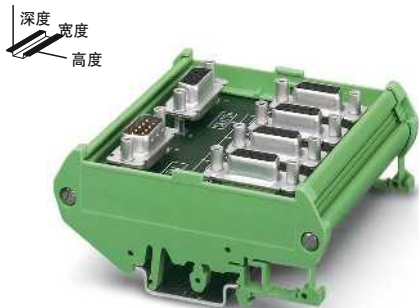
RS-485 T型分配器（6路）， D-SUB连接
