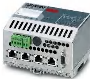
PROFINET PROFIBUS代理服务器 用于PC WORX控制系统
