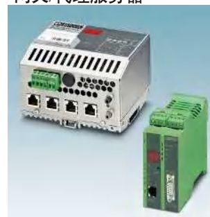
代理服务器在PROFINET网络和其他现场总线系统之间建立了连接
