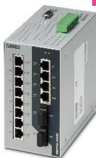
12个RJ45端口和 2个光口（单模）
