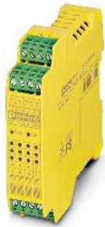
8个安全输入，4个安全输入或输出
