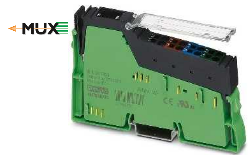
24 V DC分段回路电源 U_S
