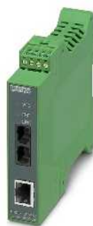
通用设备，波长1300 nm 用于单模玻璃光纤
