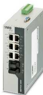
6个RJ45端口和 2个光口（多模）
