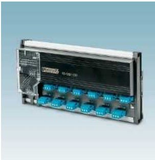
安装在Zone 1内的现场总线安全栅 页514
