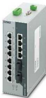
14个RJ45端口和 2个光口（多模）
