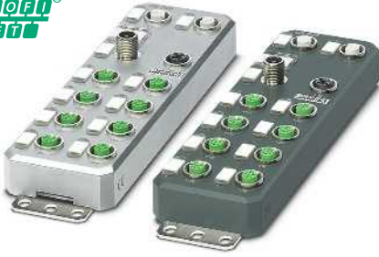
8个数字量输入和8个数字量输出
