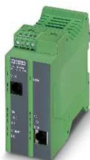
用于拨号操作的调制解调器 以太网连接 (LAN)
