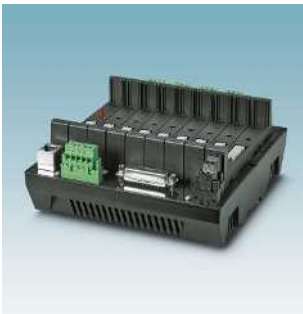
电源 冗余四通道现场总线电源基座 页517
