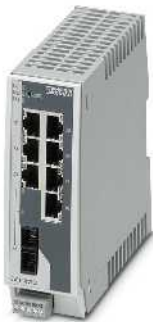
7个RJ45端口和 1个光口 (多模)
