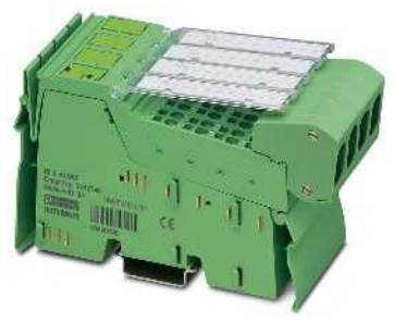
8个输入, 带启动器电源
