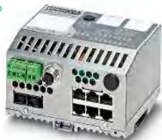
6个RJ45端口和2个SFP光口
