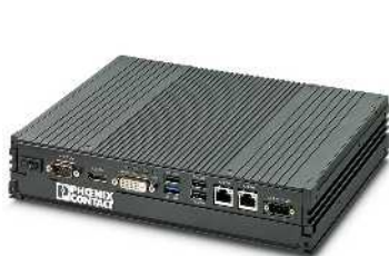
采用Intel® Core™ i3-4010U技术的嵌入式PC机，带PCI插槽
