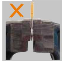
如果横联件缩短，必须使用挡板或小隔板(ZAP/TW)来维持额定电压250V，(连接在横联件被裁剪的那侧)。
