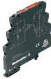
固态继电器MICR0OPTO TTL用于工业自动化应用中，调制高灵敏度的TTL信号，变为标准24VDC的电平信号。为了保护电子设备，高灵敏度的TTL信号要求和24V的电路间完全的电气隔离。为了通过5V TTL信号控制固态继电器，一个附加的辅助电压需要被接入。
