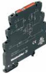
MICROOPTO SOLENOID固态继电器主要作为开关放大，应用于工作电压在24VDC和工作电流达到10A的感性执行器，例如各种电磁阀门和接触器。一个自由电位的信号触点可以向控制器传送错误信号，如短路或过载。
