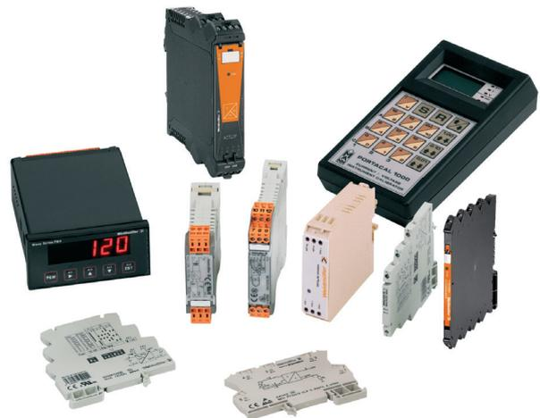
输入、输出两端隔离产品将输入信号与输出信号隔离开来。地电势的差异 — 由于远距离导线和共地参考点不同引起的这种差异 — 被消除。另外，这种电隔离也可以防止浪涌、电感和电容干扰引起的不可挽回的破坏。
