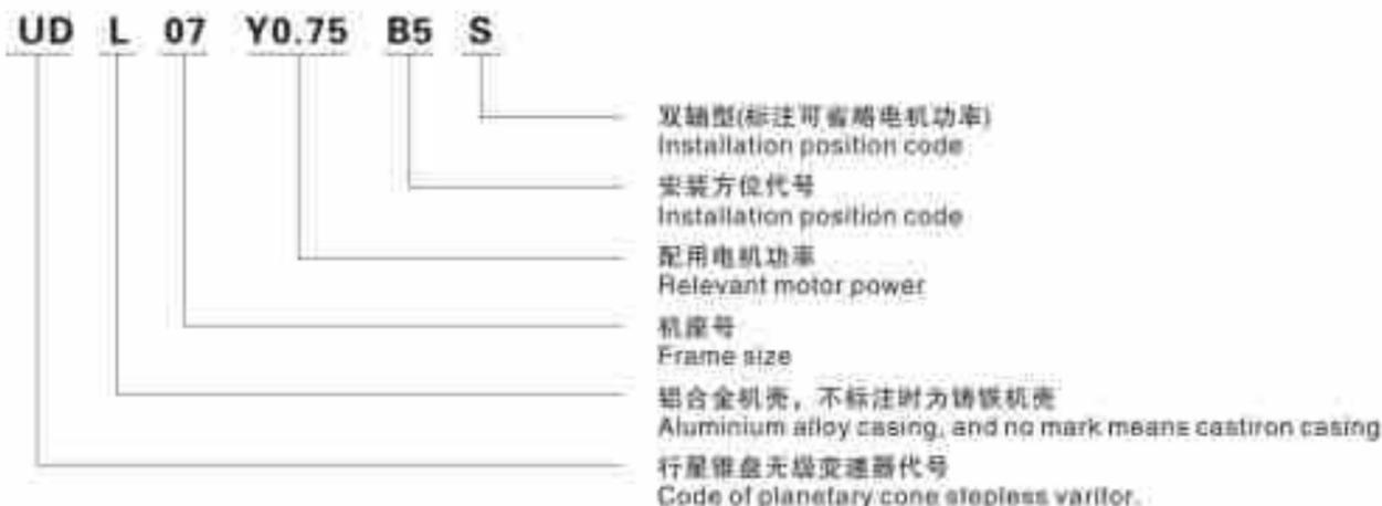
结构与原理 Structure & Principle
