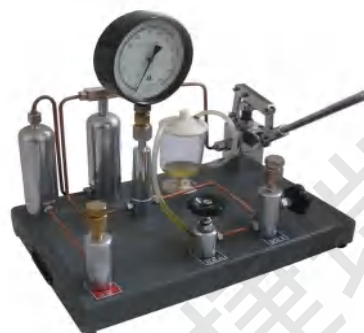
YOB型压力表氧气表两用校验台
