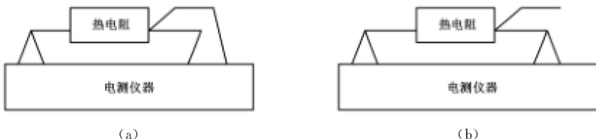
图 1 三线制热电阻测试接线方法
