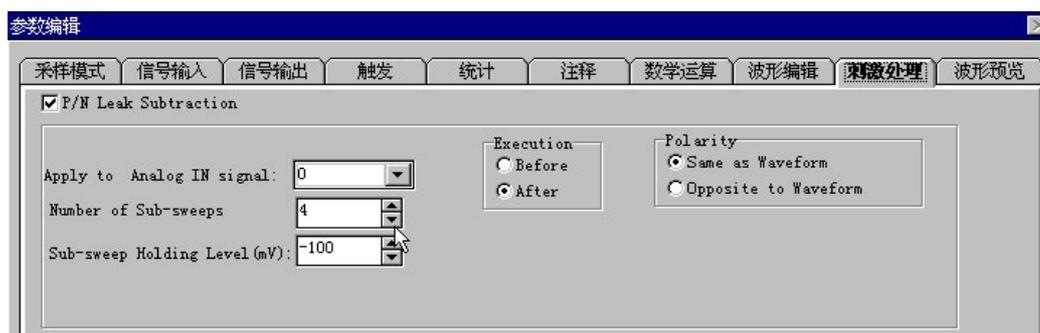
图 2.8 选择 P/n 算法消除漏电流和电容性电流伪迹
