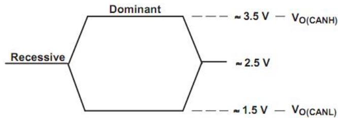
图 2 总线逻辑电压定义
