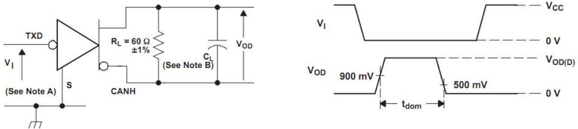
图 9 显性超时测试电路与波形
