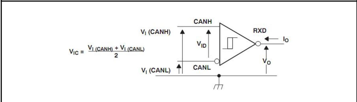
图 5 接收器电压与电流定义
