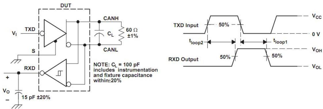
图 8  $t_{loop}$  测试电路与波形
