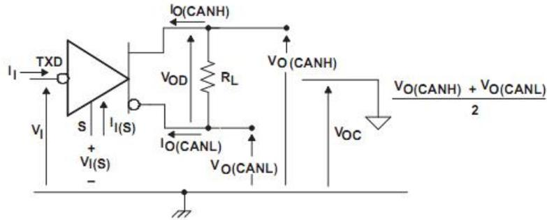
图 1 驱动器电压、电流测试定义
