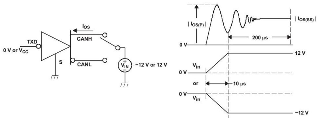
图 10 驱动器短路电流测试电路与波形
