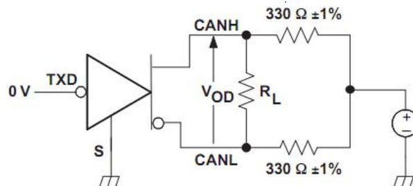
图 3 驱动器 VOD 测试电路
