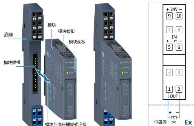
E9EX-DOF11-A 电磁阀驱动 DO 安全栅--底座结构/模块结构图
