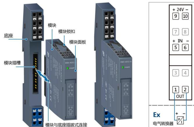
E9EX-AO11-A 模拟量输出安全栅--底座结构/模块结构图
