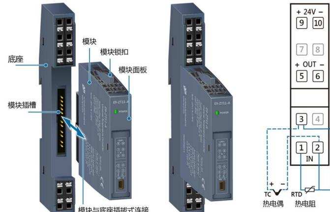
E9-ZT11-A 通用温度输入隔离器--底座结构/模块结构图
