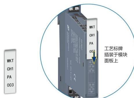
用户可在《KTS-仪表成套辅助工具软件》里完成现场传感器数据库建立和工艺工段配置，工艺标牌即可通常规打印机一键操作打印，并对应插装在产品模块面板上。
