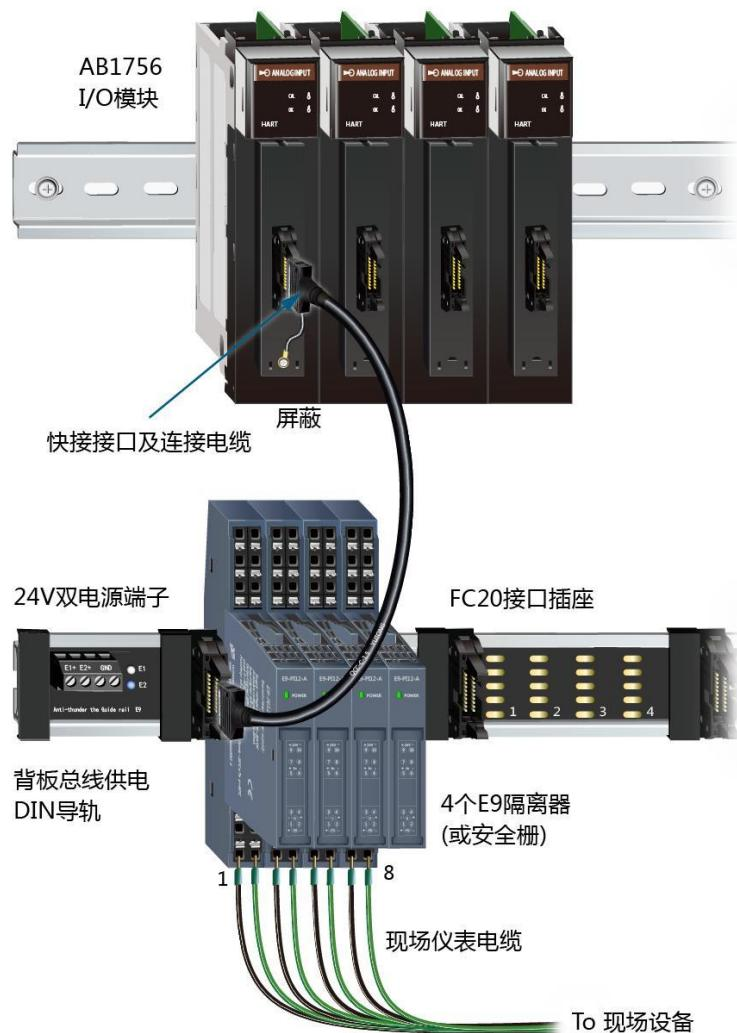
8 个 E9 系列-A 隔离器(或安全栅)与 X80 I/O 模块，通过快接接口及连接电缆快速插接。
