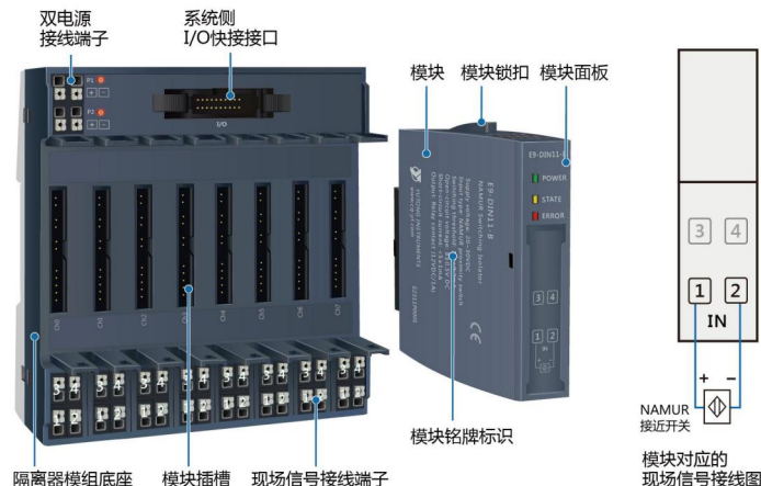
E9-DIN11/12-B 隔离器快接模组--底座结构/模块结构图/连接现场设备接线图 (注：E9-DIN12-B 隔离器快接模组的底座只配置 2 个 I/O 接口)
