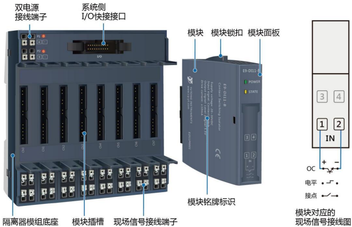
E9-DI11-B 隔离器快接模组--底座结构图/模块结构图/连接现场设备接线图
