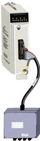
X80 BMX DDI 1602 开关量输入模块与现场分线箱转接
