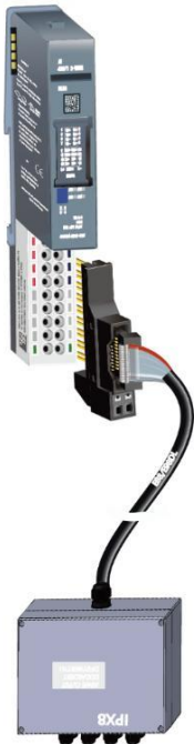
ET200SP 模块 DQ8X24VDC/0.5A 与现场分线箱转接
