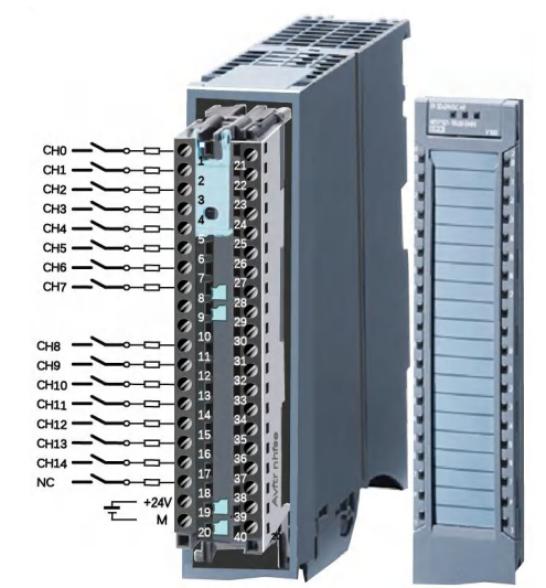
DI 16x24VDC 模块接线图
