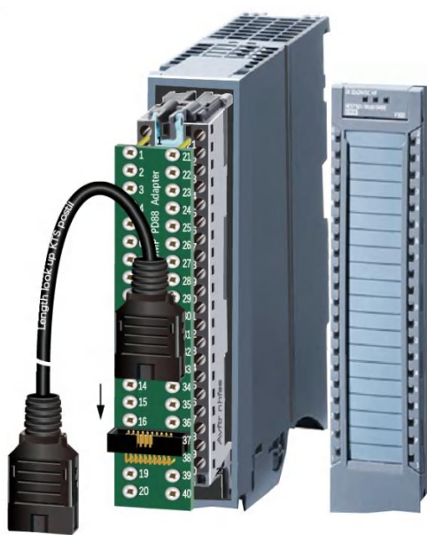
E98 PD88 与 ET200MP AI 8xU/I HS 通过[E98 PD88][AI 8xU/I HS]电缆转接
