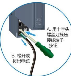
图 6 松开连接示例图
