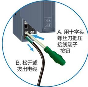
图6 松开连接示例图
