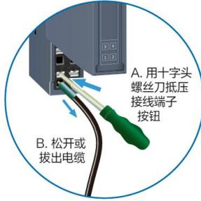
图 6 松开连接示例图
