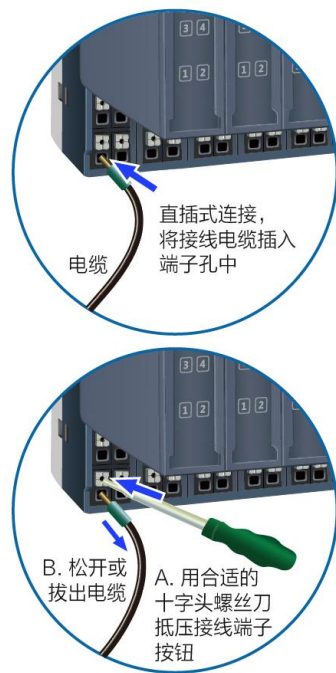
图 5 直插式连接或松开连接示例图
