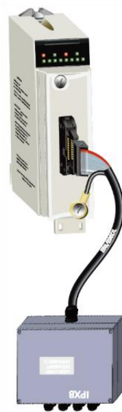
BMX DDO 1602 开关量输出模块与现场分线箱转接
