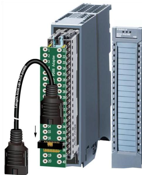
E98 DI88/DIN88 与 ET200MP DI 16X24VDC HF 转接
