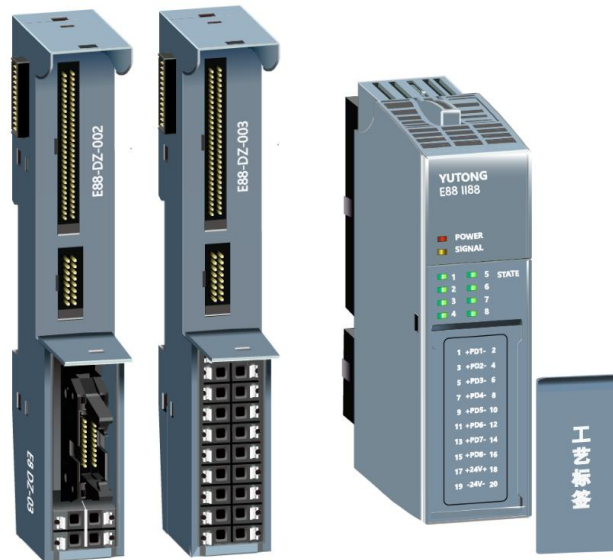
E88 II88 输入接线端子图
