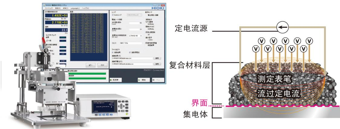
图 4 电极电阻测量系统 RM2610
