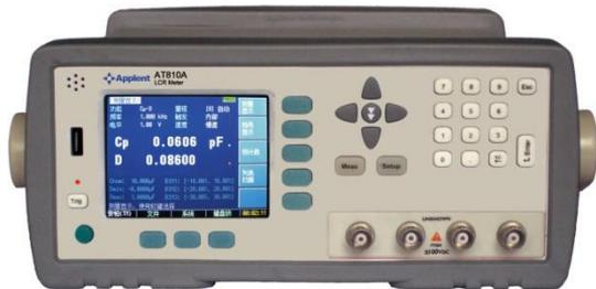
AT810A 精密 LCR 数字电桥是使用最新技术设计的 LCR 数字电桥，**10Hz~20kHz 连续频率**覆盖了所有低频频点，**0.01V~2.00V 连续电平**设置，主副四参数全 6 位显示，**0.05%**的基本准确度，使得 AT810A 同类产品性能上遥遥领先。完善的低频测试性能和丰富的接口，AT810A 足以应付任何情形下的测试。AT810A 改进了 Handler 接口以适应更多分选机的要求。AT810A 为流水线生产提供了既廉价又高精度的最佳解决方案。新升级版本采用**大字体显示**，读数更加直观。
