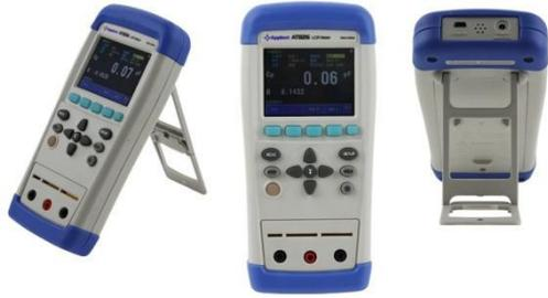
AT826 系列手持电桥采用高性能 32 位 ARM 微处理器控制。超低功耗设计和高密度 SMD 装配工艺,真彩 TFT 液晶显示屏,并具有**键盘,触摸屏双控制**。摆脱了工作台的限制,为您移动 LCR 测量提供方便。采用锂电池供电,USB 通讯。中英文操作界面可快速切换。**仪器标配的数据采集软件**为您进行数据分析提供强有力的支持!是目前手持 LCR 数字电桥的最高配置! AT826 系列手持电桥最高 100kHz 的测量频率,恒定 100Ω源内阻,0.6Vrms 测量电平,最高 0.2%的测量精度,兼备了手持表的便携型和台式仪器的优越性能!
