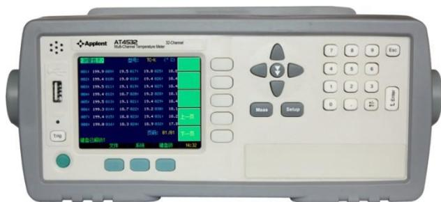
AT45 系列多路温度测试仪采用高性能 ARM 微处理器控制，可同时对多路温度数据进行采集，上超下超报警和通讯传输，并可扩展至 128 路温度数据，兼容多种温度传感器，响应速度快，数据稳定，同时具备断偶检测功能。
