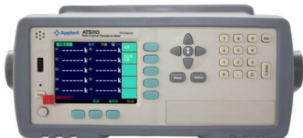
AT5110 AT5120 是全新设计的高精度宽量程、多路电阻测试仪，可以对**多路电阻**进行扫描测试。并且每个通道可以**单独设置比较器**。AT5110, AT5120 采用高性能 ARM 微处理器控制。真彩 3.5 吋液晶可**同时显示多路电阻值**，可以测试  $1\mu\Omega \sim 30k\Omega$  的电阻，最大显示 30,000 数。仪器标配的温度补偿功能可以适应不同要求的测试。应用于自动化设备，可使用 RS232C 及 HANDLER 接口输出 10 路的 GD/NG 信号，以提高生产自动化测试能力！
