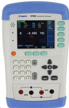
AT518 手持式直流低电阻测试仪是一种高精度宽量程，采用高性能 32 位 ARM 微处理器控制的全自动实时检测的微型手持式仪器，在任何场合可长时间实现对无源器件进行精确而便捷的测量。仪器可以测试  $10\mu\Omega \sim 20M\Omega$  的电阻，最大显示数 20000 数。标配温度补偿功能，测试速度在 15 次/秒下，依然可以保证 0.05% 的精度，并且读数跳动控制在 3 字以下。它独有的电流测试模式可以适应不同要求的测试。并配备 Mini-USB 通讯接口，用于远程控制和数据采集与分析；以及 U 盘接口，可以记录被测件的数值变化。
