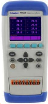
AT42 系列手持多路温度测试仪采用高性能 32 位 ARM 微处理器控制，可同时多路温度数据进行采集，上超下超报警和通讯传输，兼容多种温度传感器，响应速度快，数据稳定，同时具备断偶检测功能。超低功耗设计和高密度 SMD 装配工艺，真彩 TFT 液晶显示屏，并具有键盘、触摸屏双控制。采用锂电池供电，USB 通讯。中英文操作界面可快速切换。仪器标配的数据采集软件为您提供数据分析提供强有力的支持！最新升级版支持 **TF 卡存储** 和 **USB 磁盘存储器**，实时存储采样数据。
