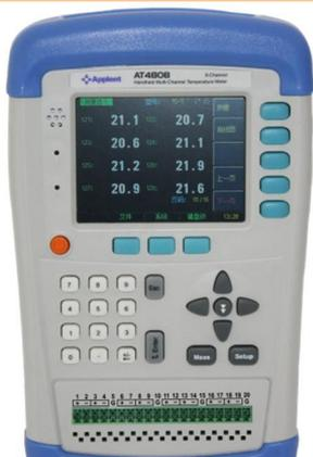
AT4808 手持式多路温度测试仪采用高性能ARM 微处理器控制，可同时对多路温度数据进行采集，上超下超报警和通讯传输，并可扩展至 128 路温度数据，兼容多种温度传感器，响应速度快，数据稳定，同时具备断偶检测功能。
