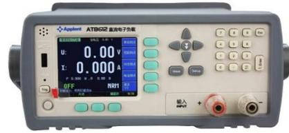
AT8612 直流电子负载采用高性能 ARM 微处理器控制, 中英文菜单显示, 提供四种工作模式: 定电流 (CC)、定电压 (CV)、定功率 (CP) 和定电阻 (CR), 6 种测试功能: 正常测试功能 (NRM)、动态测试功能 (TRN)、顺序列表测试 (SEQ)、自动列表测试 (ATF)、电池测试功能 (BAT) 以及短路测试功能 (SHT)
