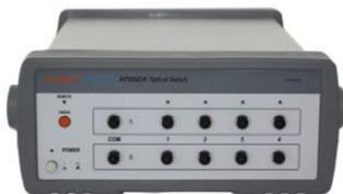
AT5524 系列光开关具有极低的插入损耗 ( 典型值 $\leq 0.6\text{dB}$ 、最大值 $\leq 1.0\text{dB}$  ), 性能处于业界领先水平。通过前面板可人工切换状态。通过光功率可通过前面板显示。AT5524 系列光开关主要应用于需要高可靠运营的光路切换、光设备切换。如有线电视系统前端 1550nm 光发射机, 光纤放大器的热备份自动切换, 重点保护光路的光路由切换, 自愈性环网。也可用于动态配置的分播复用器 ( CADM )、交叉连接器 ( OXC ), 系统监测与故障保护。
