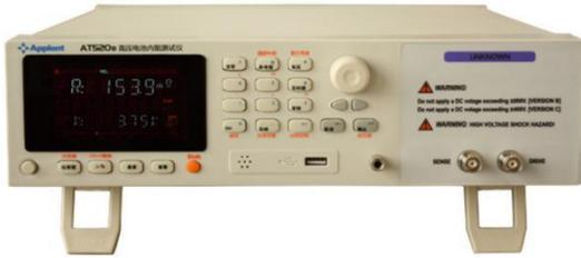
AT520B AT520C 是全新设计的**高压电池测试仪**，针对高压电池进行电压和内阻测量，内置直流高压表。AT520B 可以测量 **0.1mΩ~300Ω** 的电池内阻，并且同时可以测量最高 **780V** 的电池电压，适用于各类高压电池的测试，例如多节串联高压锂电池电压和内阻测量。
