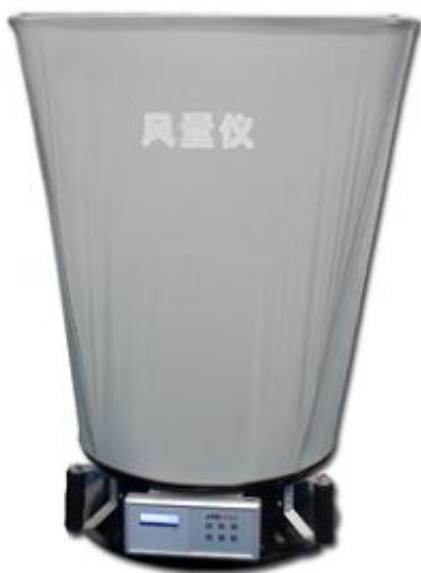
**【适用范围】：**广泛应用于暖通空调、净化技术等行业进行风口和管道风量的直接测定，从而对集中空调的风量实施综合管理及温度、湿度、洁净度等参数的自动控制。
