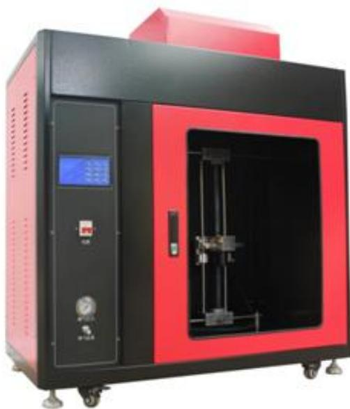
**【适用范围】:** 主要用于测试医用口罩以一定线速度接触火焰后的燃烧性能, 是医用口罩阻燃性能专用测试仪器。
