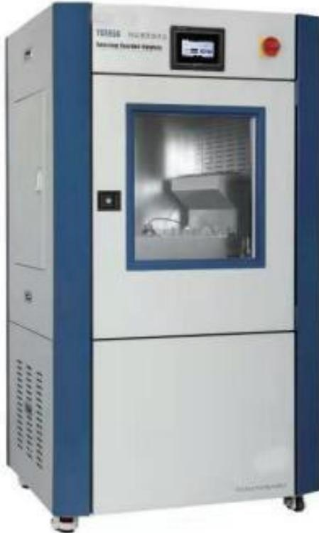
**【适用范围】:** 适用于纺织品、服装、床上用品、睡袋、室内装饰物、薄膜、涂层材料、泡沫、皮革、多层织物组合的纺织品等平面材料的热阻和湿阻测试。
