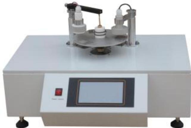
**【适用范围】：**本仪器适用于测定织物或各种非金属材料的板状制品或片状制品的静电性能。
