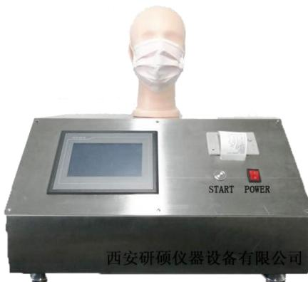
**【适用范围】：**本仪器用于呼吸阻力的测试, 其测试方法符合 GB2626-2019 标准, 具有测试数据准确、稳定、使用操作简便等优点。
