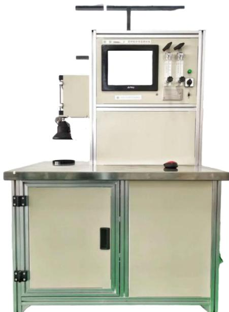
**【适用范围】:** 本仪器根据国内相关行业的测试现状。自主研发的程序软件运行稳定可靠、操作方便。简洁运行界面，运行参数一目了然。不同尘源（DEHS 和 NaCl）切换自如，适用于多种空滤材料（熔喷、玻纤、PP、覆膜等滤材）、医用口罩及部分劳防用品的测试。
