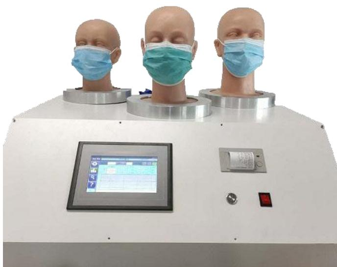
**【适用范围】：**本仪器用于呼吸阻力的测试，其测试方法符合 GB2626-2019 标准，具有多头模、测试数据准确、稳定、使用操作简便等优点。
