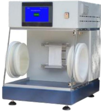
**【适用范围】:** 本仪器在规定的实验室环境条件下,适用于测定医用防护服和可热封柔韧性防静电阻隔材料的静电衰减性能,给定测试材料的高压电场,接着测量电荷衰减时间。
