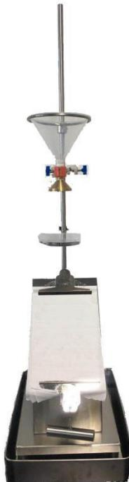
**【适用范围】:** 用于织物在低冲击条件下抗渗水性能的测定，从而预测服用织物的抗淋雨渗透性能。
