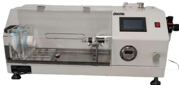
**【适用范围】:** 医用外科口罩合成血液穿透测试。仪器的原理是通过高压压力的输出实现对测试产品的高压穿透测试。
