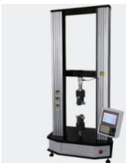
**【适用范围】：**用于测试织物、无纺布、纸张、织带和非织造布等各种材料的断裂强力、断裂伸长率、撕破、剥离、顶破、纰裂和接缝滑移等各项力学性能。并有定速度、定位移、定时间、定负荷、定伸长等各种测试功能。
