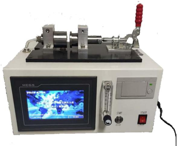
**【适用范围】：**适用于医用外科口罩气体交换压力差的测定，也可用来测定其它纺织材料的气体交换压力差。
