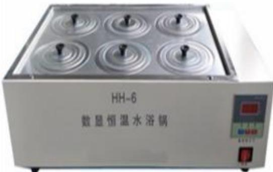
**【适用范围】:** HH 系列数显恒温水浴锅广泛应用于实验室样品的干燥、浓缩、浸渍，也可适用于水浴恒温加热及其它试验，其工作室采用优质304 不锈钢内胆，具有较好的抗腐蚀性。
