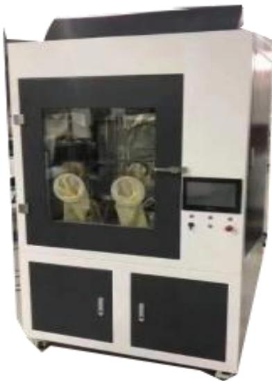
**【适用范围】：**细菌过滤效率测试仪（BFE）用于在某些环境条件下测试诸如口罩或防护服等细菌材料的过滤材料的过滤效率。
