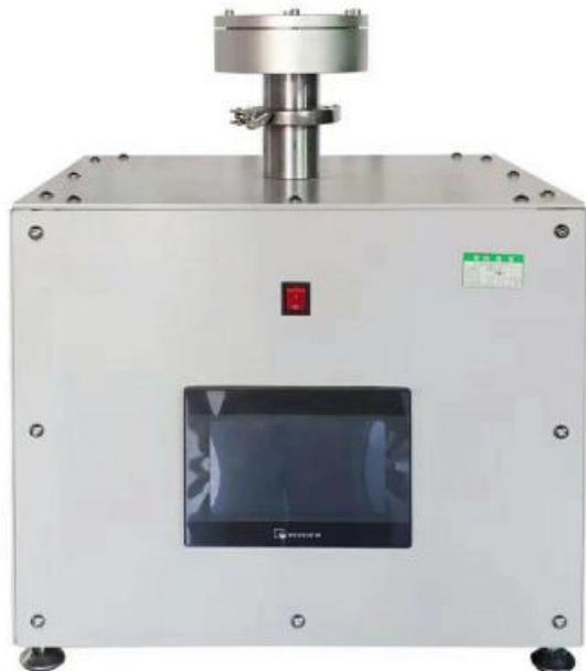
**【适用范围】：**将呼气阀安装于合适的夹具上，再将夹具内部抽成负压状态，监测整个夹具装置恢复到常压的时间，从而评判呼气阀的气密性。
