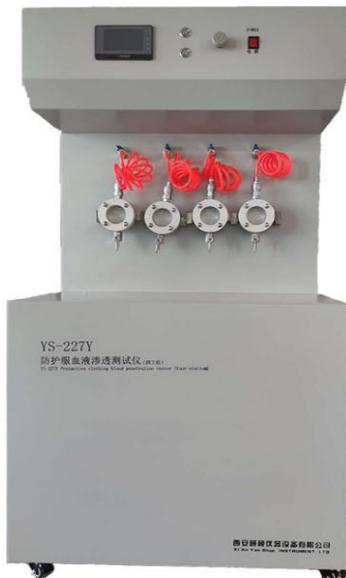
**【适用范围】：**用于测试织物、无纺布等材料制成的医用防护服在不同水平试验压力下对合成血液穿透的抵抗能力。
