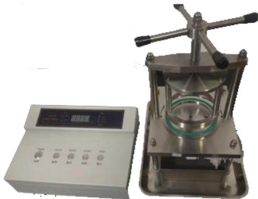
**【适用范围】:** 用于织物耐静水压测定，也用来测定涂层材料的耐静水压性能。
