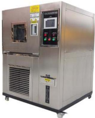
**【适用范围】:** 恒温恒湿试验机又名环境试验机，试验各种材料耐热、耐寒、耐干、耐湿性能。适合电子、电器、食品、车辆、金属、化学、建材等工厂品管之用。
