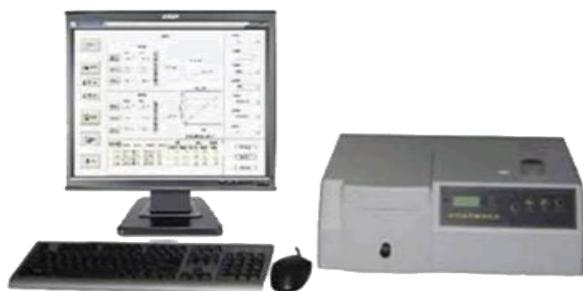
**【适用范围】:** 纺织品甲醛测定仪是应用计算机技术、对于纺织品试样溶液比色、处理，测定各种纺织品中的甲荃含量，测得结果可长年存储并打印输出。
