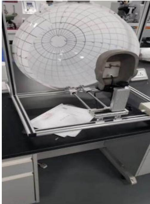
**【适用范围】:** 根据相关标准生产,主要用于口罩、面罩、呼吸器等的视野测试。适用于口罩及呼吸器生产企业、质量监督、科学研究、佩戴使用等单位。
