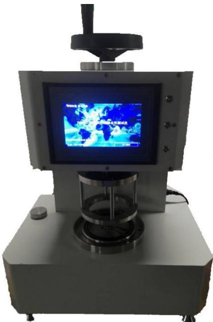
**【适用范围】:** 该仪器用于测量经过防水处理的各种织物的耐水渗透性, 例如帆布, 油布, 帐篷布, 防水油布, 防雨布和土工织物材料;
