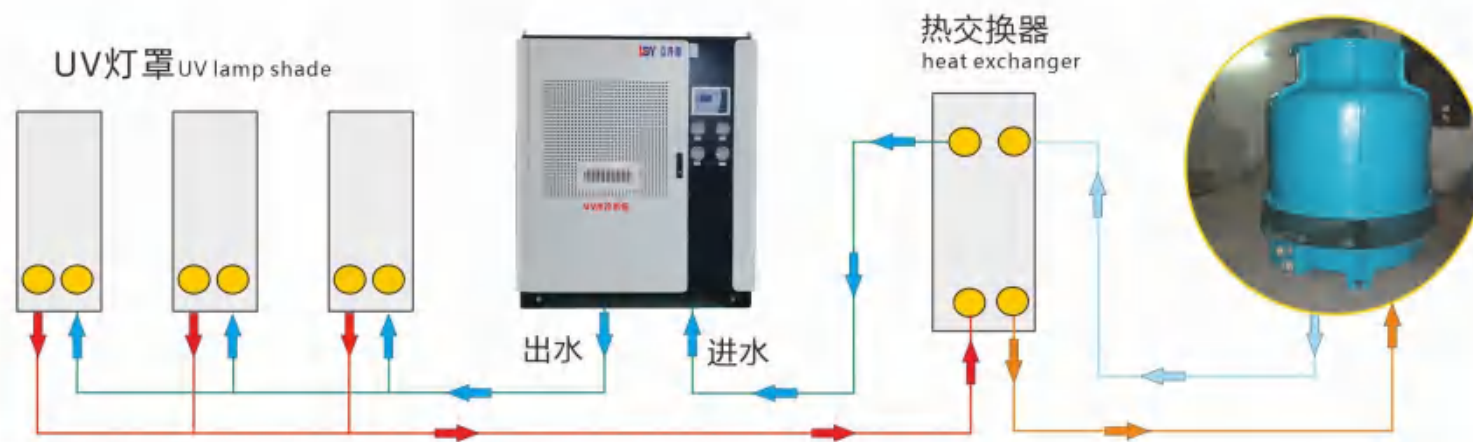
“水冷式”冷却系统工作原理
