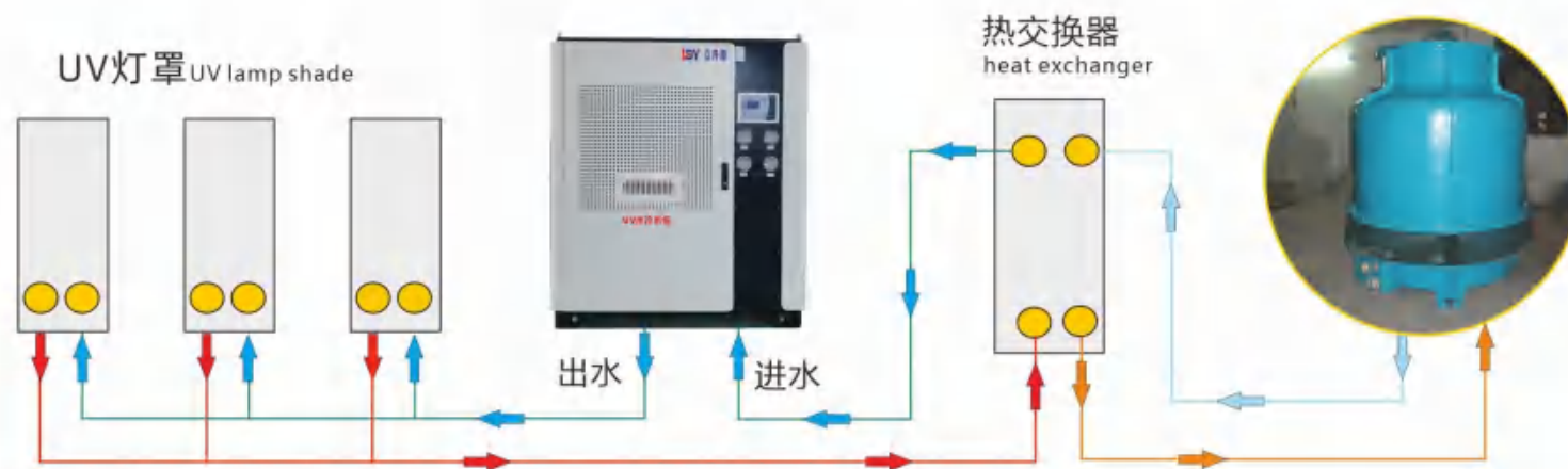
“水冷式”冷却系统工作原理
