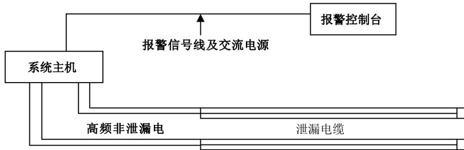
当 TRX-100 II 型多套连接使用时，规范用法是相邻两套电缆首尾相接，由于泄漏电缆始端存在 3 米左右过渡区，为确保相邻两套连接探测器接合区域可靠探测，在安装时应保证相邻两套泄漏电缆首尾间有 3 米左右重叠区，并且使两套电缆间在重叠区保持有 0.3 米左右的间隔（注意：每套主机有左右两个电缆端口，只有同是连接左端口或右端口的电缆可以重叠）。同时，相邻两套的泄漏电缆的主机的工作频率应错开，即选择编号最后不同字母的泄漏电缆的主机。如：编号 xx-xxxA 或 XX-xxxB 等。
