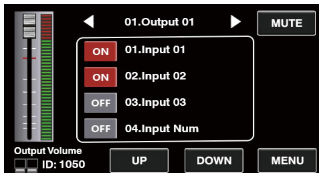
您可以调节输入音量，静音，通过本页的音量指示器可以看到输入音量的变化；
