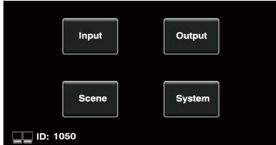
将Matrix-A8的RD端口连接到RVC300的IN端口。矩阵-A8成功识别并连接到RVC300后，左下角的指示灯将变灰，同时也将显示分配给RVC300的设备地址矩阵-A8。点击主界面上相应的按钮，即“输出设置”、“输入设置”、“场景设置”、“系统设置”，可以分别进入四格子页面。
