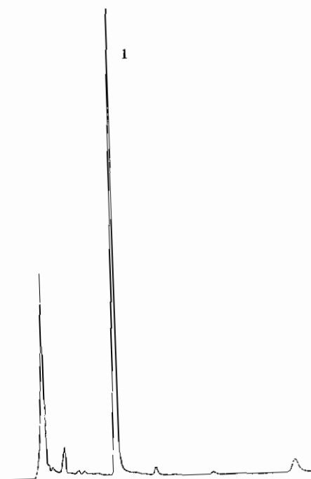
图 2 代森锰锌可湿性粉剂中 ETU 的液相色谱图
