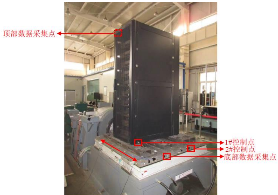
图 5：机柜动态测试现场照片
