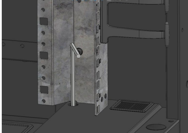
图 37：机柜内部调节支脚高度示意图
