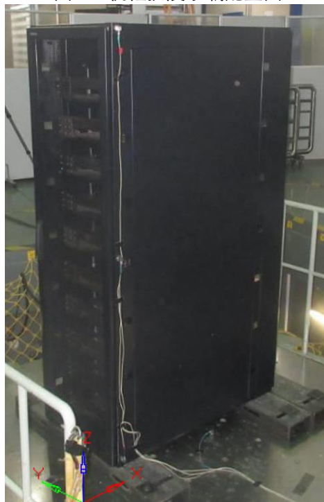
图 7: 机柜抗震测试设备上照片
