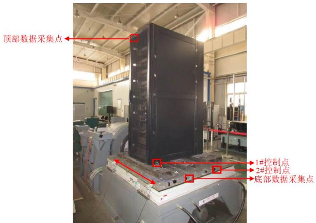
图 5：机柜动态测试现场照片
