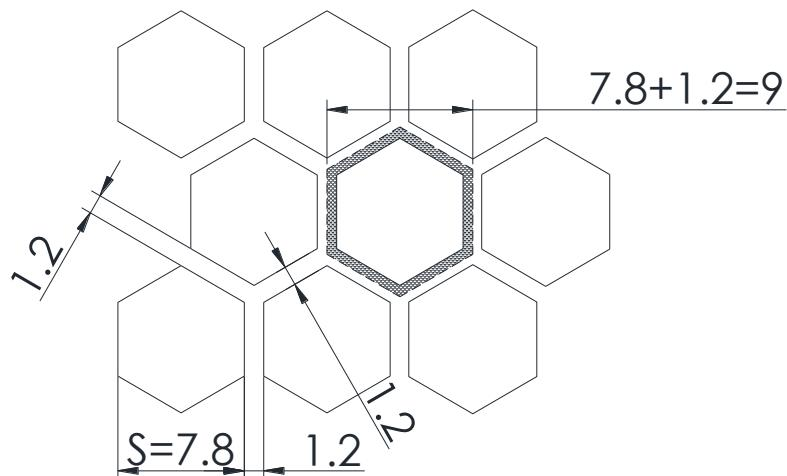
图 11：机柜门板上六角孔示意图
