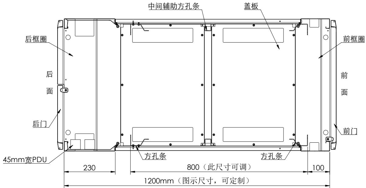
图 17：机柜内部方孔条安装位置示意图
