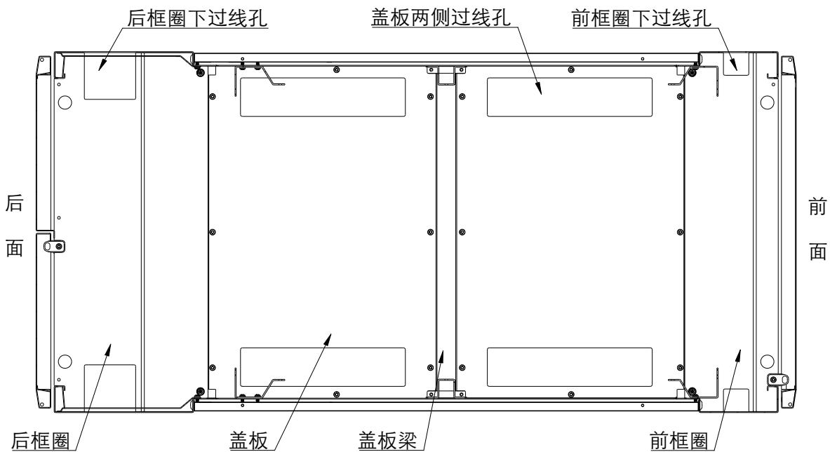
图 25：机柜底部过线孔位置示意图
