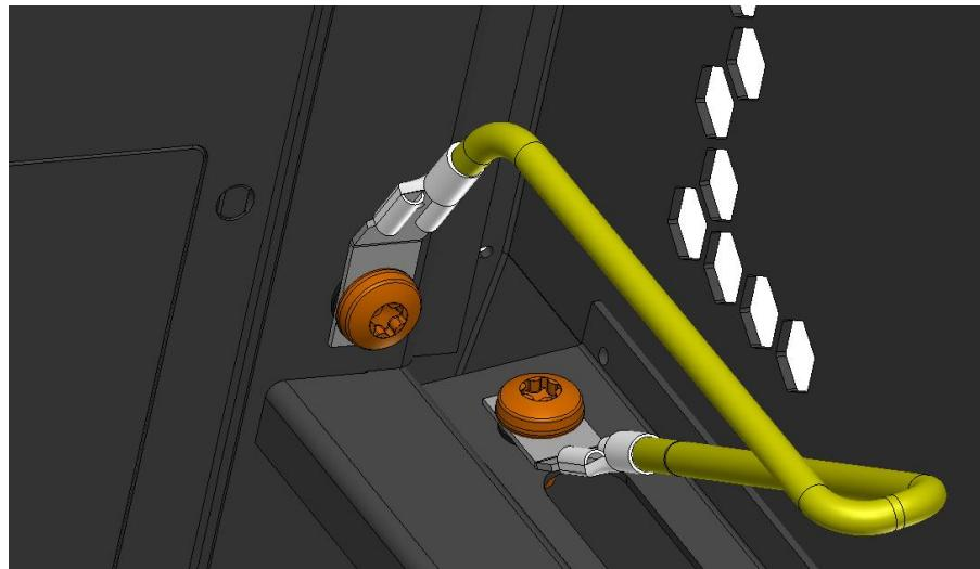
图 10：机柜内部接地线组件连接示意图
