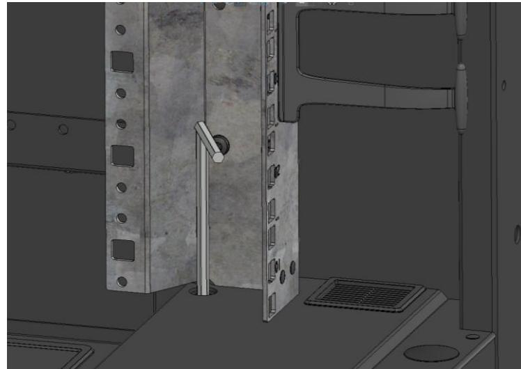
图 37：机柜内部调节支脚高度示意图
