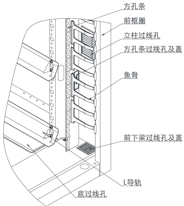
图 27：机柜内部过线孔位置示意图
