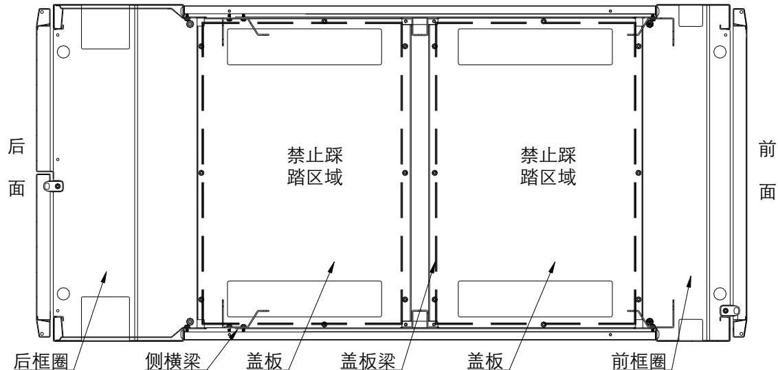
图 9: 机柜底部禁止踩踏区域示意图
