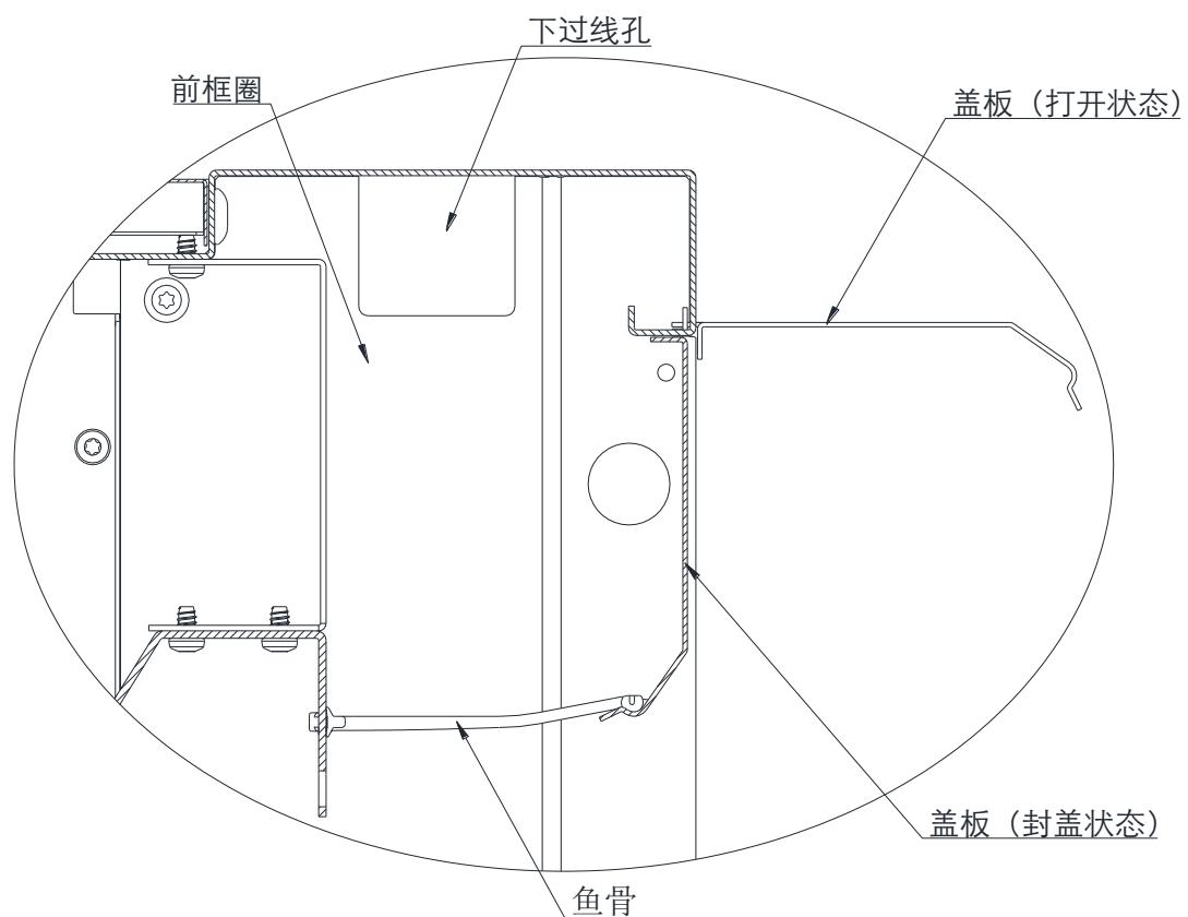
图 22：800 宽机柜前部走线槽示意图
