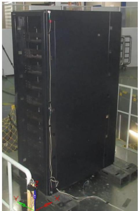
图 7：机柜抗震测试设备上照片
