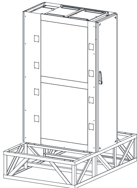
图 35：机柜安装于钢架上示意图
