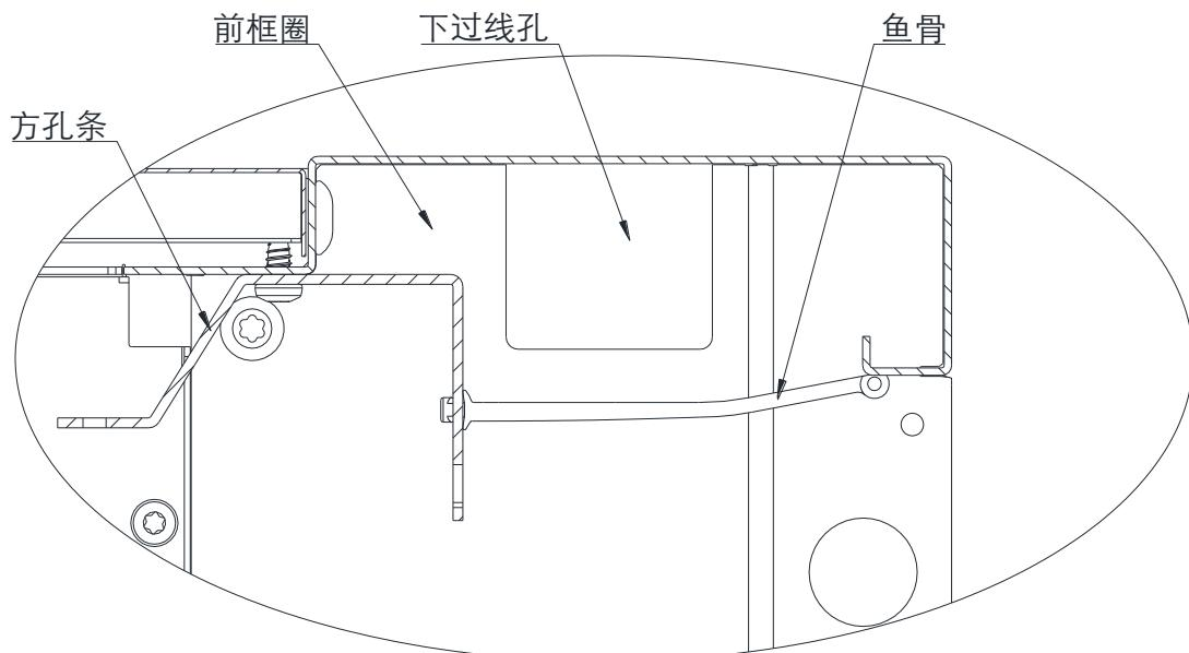
图 21：600 宽机柜前部走线槽示意图
