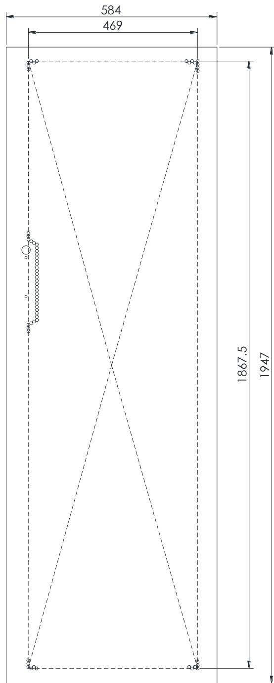
图 12：机柜门板开孔区域示意图
