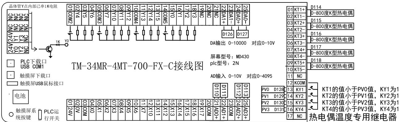
输入属于NPN型，不需要外接电源，直接短接COM和X点即可。
