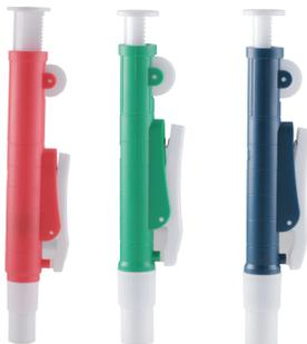
助吸器可取代传统洗耳球，通过转动滚轮来进行精确的取液和分液，从而实现单手操作移液管过程。
