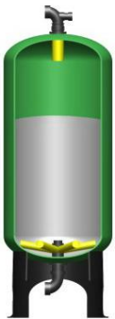
4寸侧装布水器安装效果
