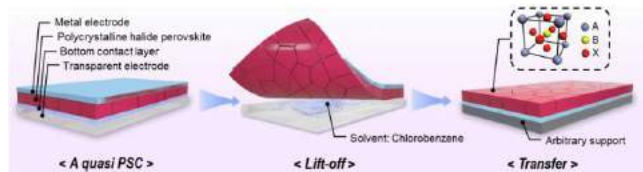
图2. 钙钛矿多晶薄膜剥离技术
